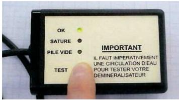
Le **RÉSISTIVIMÈTRE À PILE ECO 100+** (ref 00553783) est un appareil de contrôle qui permet de suivre l'état de saturation de votre déminéralisateur.
